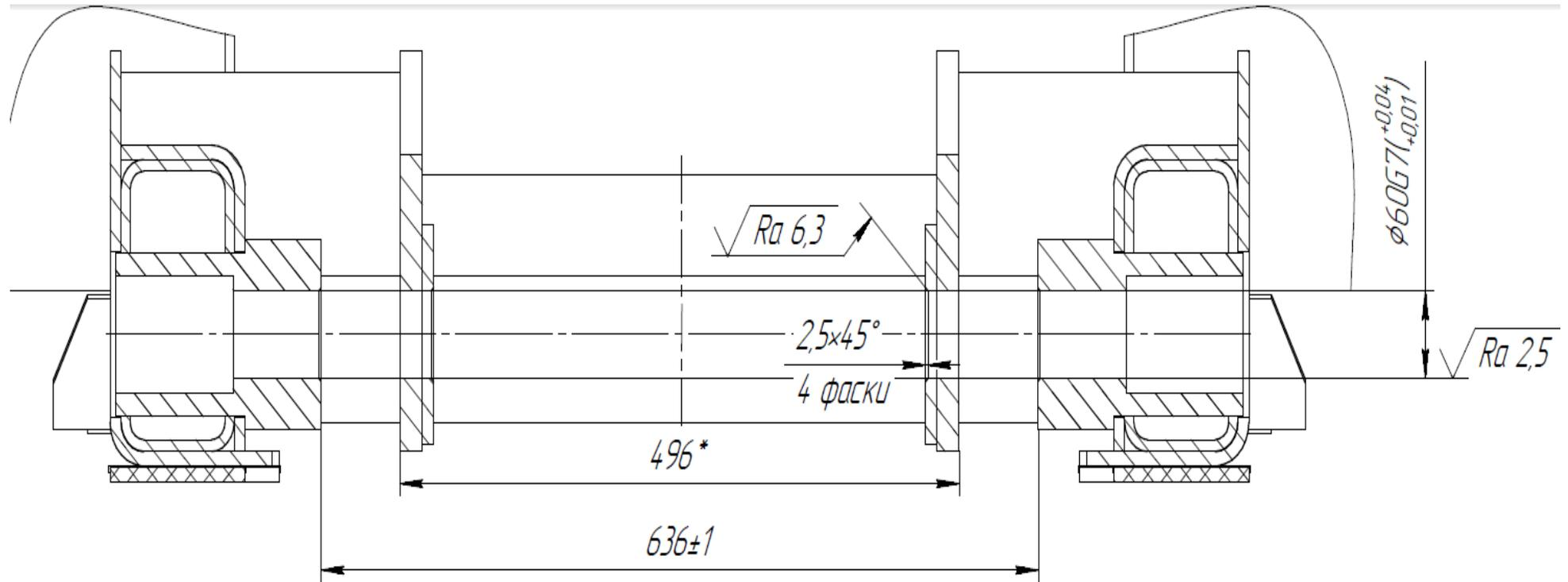
Установка №4: - расточить отверстия и обработать 4 фаски. Длина расточки, два по 180 мм.
